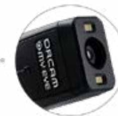
Activation des leds dans l'obscurité.
